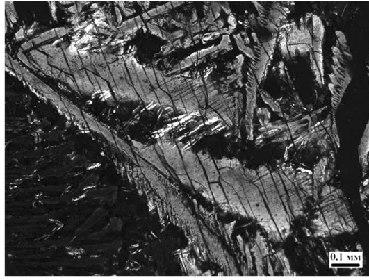
4. Фото шлифа САТ-04-04. Зерно твердого раствора геленита с акерманитом со спайностью. Николи скрещены.
