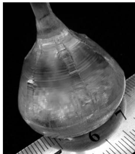
Рис. 3. Фотография кристалла \text{Ba}_2\text{Na}_3[\text{B}_3\text{O}_6]_2\text{F} , выращенного в системе \text{BaV}_2\text{O}_4\text{--NaF} на ориентированную затравку.
