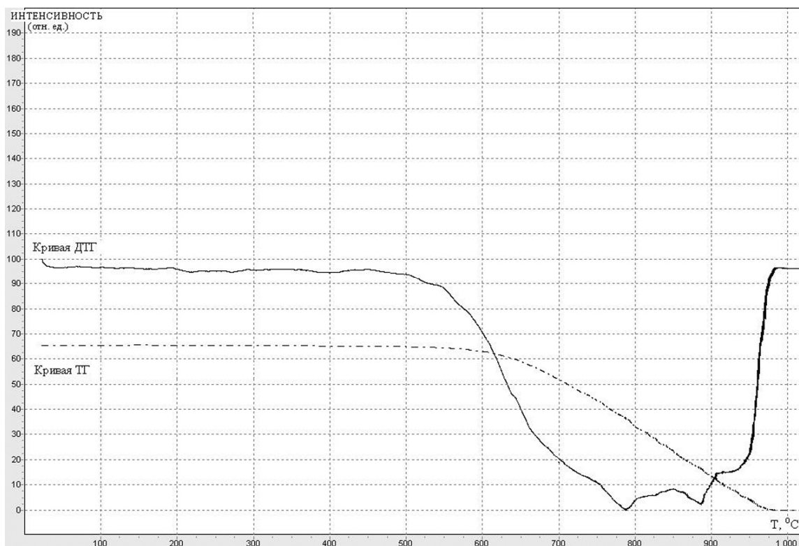
Рис. 2. Кривая ТГ-ДТГ графита после удаления карбонатной составляющей.
