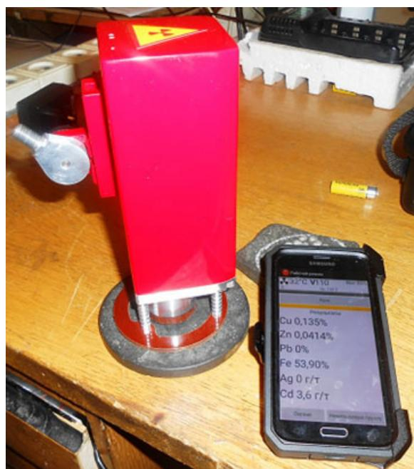
Рис. 2. EDXRF спектрометр РПП-12Т.
