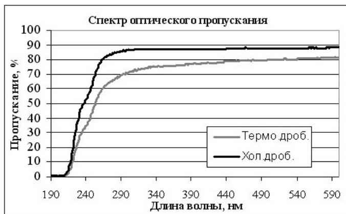
Рис. 3. Спектры пропускания кварцевых стекол, выплавленных из промышленной кварцевой крупки жилы «Беркутинская», полученной флотацией, и крупки кварца этой же жилы, приготовленной агломерацией.
