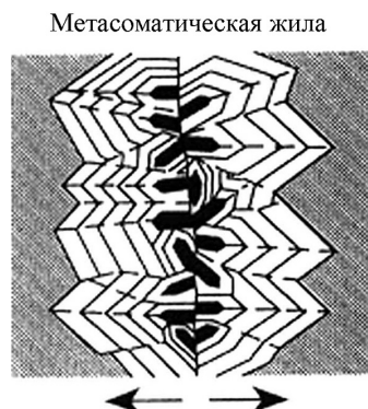
Рис. 9. Схема строения метасоматической жилы с зонами геометрического отбора (чёрное); стрелки указывают направление преимущественного роста кристаллов.
