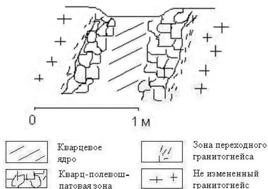
Рис. 1. Схема строения пегматитовой жилы.
