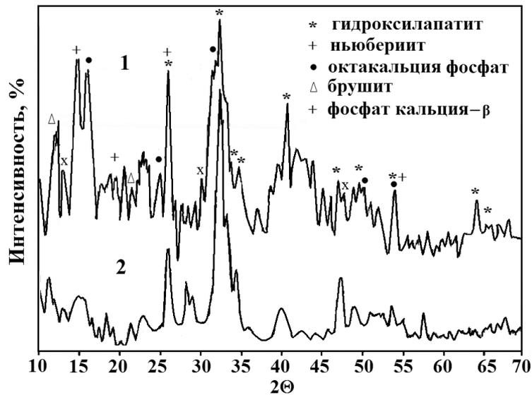
Рис. 1. Дифрактограммы образцов, синтезированных при pH = 7.4 (1) и pH = 7.8 (2).
