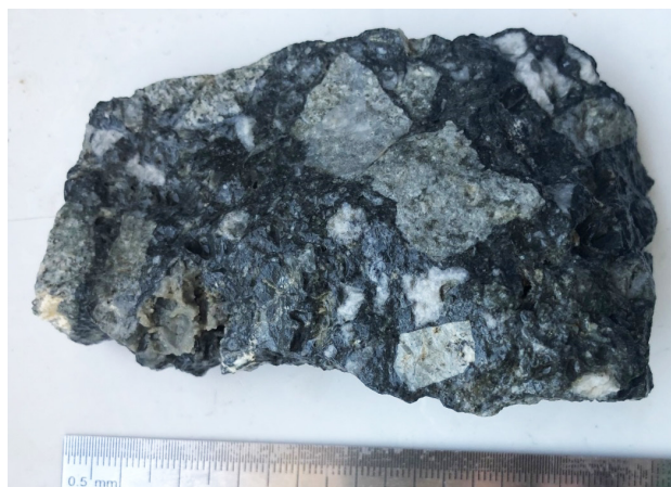
Рис. 1. Эксплозивно-гидротермальная брекчия месторождения Жильное.
